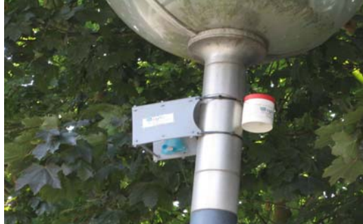
Figure 3 : Tubes à diffusion passive dans leurs boîtes de protection
