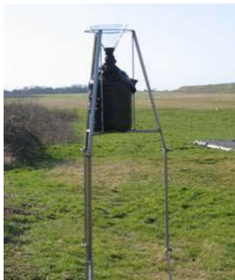
Photo 1: Préleveur passif type Jauge Owen sur trépied.
