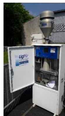
Figure 3 : Appareil de prélèvement de particules sur filtre pour la caractérisation chimique des particules
