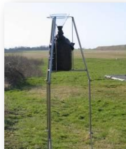
Photo 1 : Préleveur passif type Jauge Owen sur trépied
